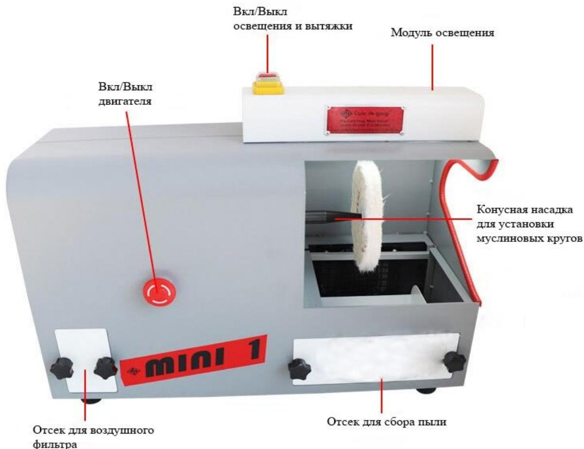
Конструктивно установка выполнена в виде модуля, состоящего из основания, с установленным на нем шлифовальным мотором и защитным кожухом. На одной оси с
